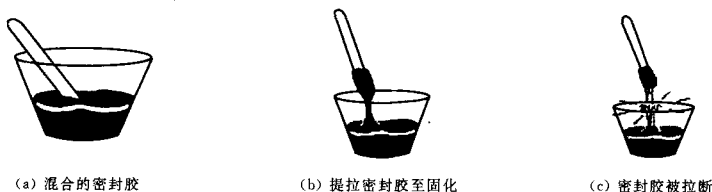
图 D.4 拉断时间试验
